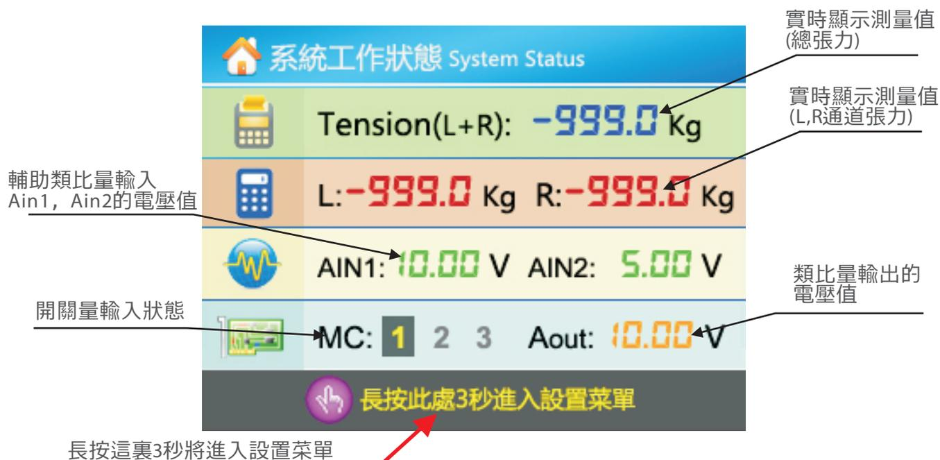
1. 張力測量值顯示：Tension(L+R)顯示的是檢測器L和檢測器R疊加的總張力值。L, R分別顯示L通道和R通道的測量值。
