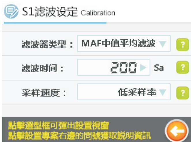
其中，點擊濾波器類型後面的輸入框，可彈出一個濾波器類型選擇窗口，濾波器類型可已選擇為以下幾種：
